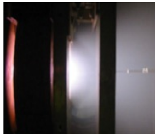
磁石から噴出する超音速プラズマジェット
